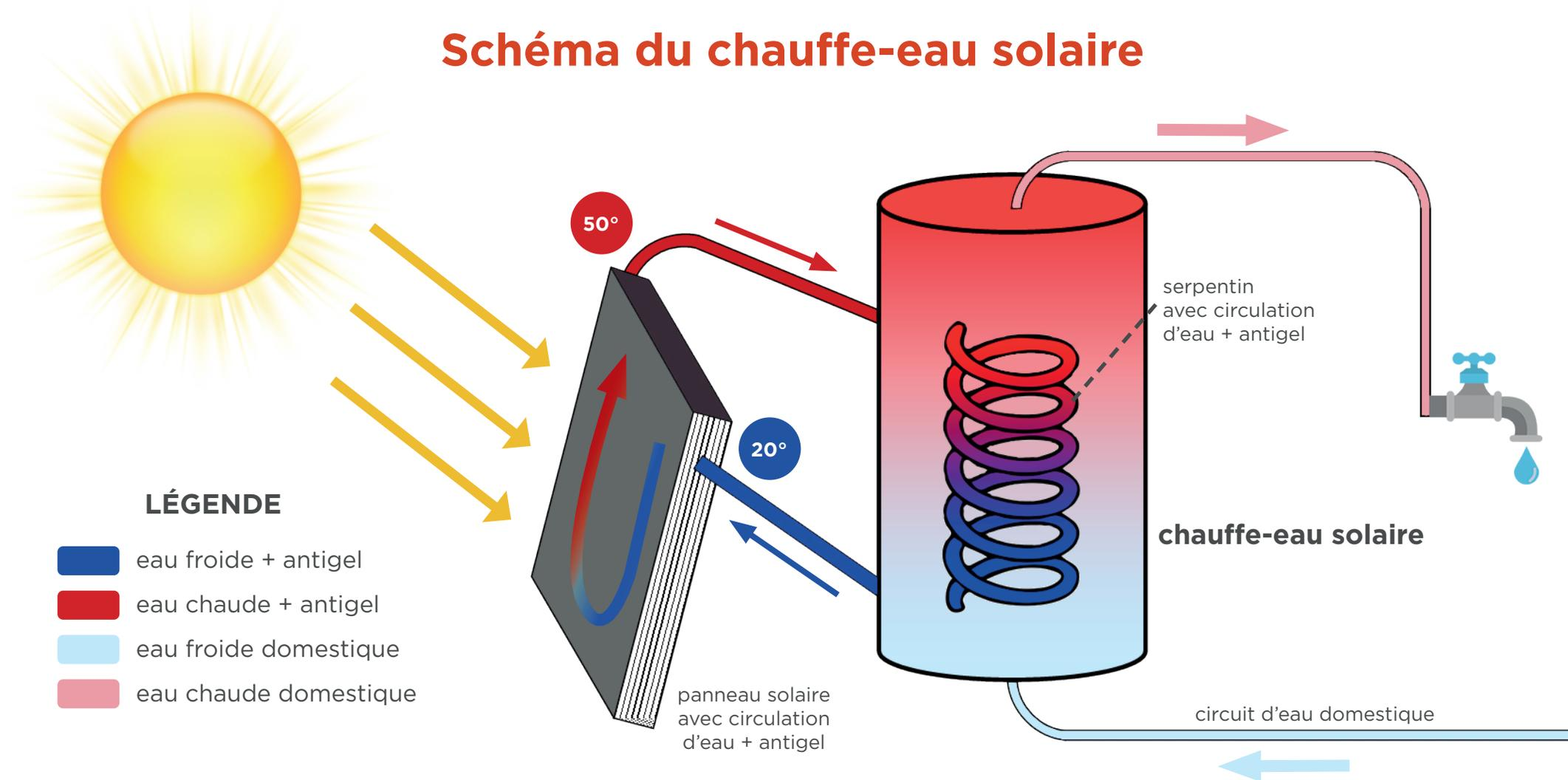
Le capteur solaire est constitué d'une plaque et de tubes métalliques noirs. Un fluide caloporteur (eau + antigel) circule à l'intérieur. Quand il fait soleil, le fluide se réchauffe. Il sort du panneau et va dans un serpentin qui se trouve dans le ballon. Le ballon est une réserve d'eau domestique. Le serpentin (échangeur) permet le transfert de la chaleur solaire à l'eau du ballon. L'eau chaude sort par un robinet qui se trouve dans la grange.
